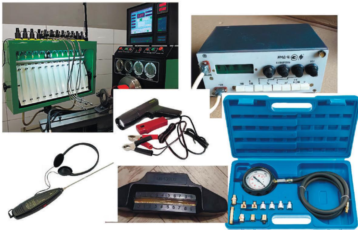
**Рис. 2.126.** Діагностичне обладнання для господарств, парк яких налічує до 10 машин
