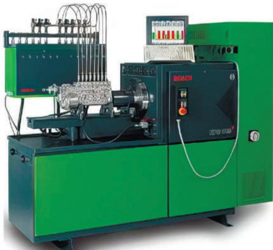
Рис. 2.129. Діагностичний стенд EPS 815
