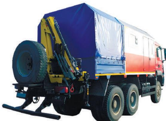
**Рис. 2.20.** Ремонтно-діагностична майстерня AVTR-AP33M6402-K на шасі автомобіля-фургона MAN з комплектом необхідного обладнання
