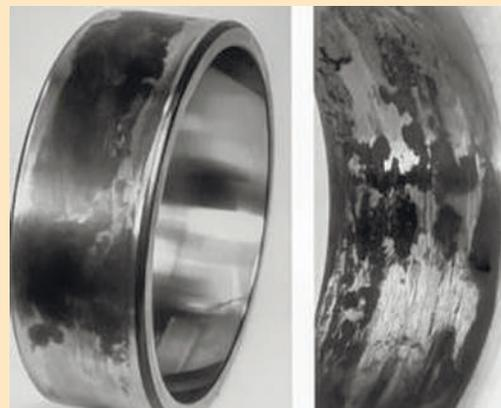
**Рис. 1.15.** Контактна фретинг-корозія підшипників
