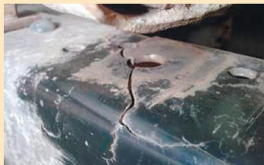
**Рис. 1.14.** Зношування металу від утомленості
