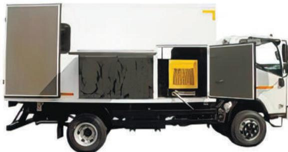
Рис. 2.27. Пересувна оливозаправна станція АП25Z4206-0S на базі шасі ISUZU NP R75LH
