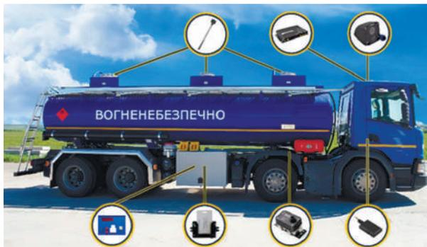
Рис. 2.238. Розміщення датчиків контролю системи GPS-моніторингу на бензовозі
