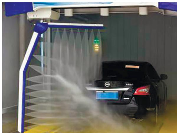
Рис. 2.89. Струминна мийна установка
