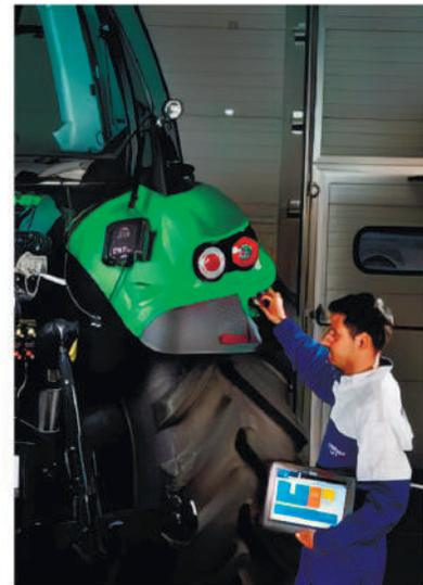
**Рис. 2.127.** Мультимарочний діагностичний прилад для сільськогосподарської та будівельної техніки Texa Navigator TXTs OHW
