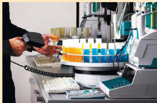
Рис. 1.20. Лабораторне обладнання для хімічного аналізу оливи
