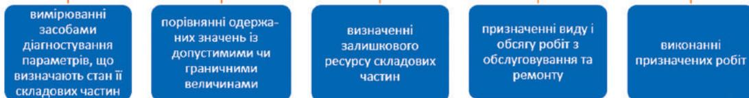
**Рис. 2.37.** Перелік робіт під час керування технічним станом машини
