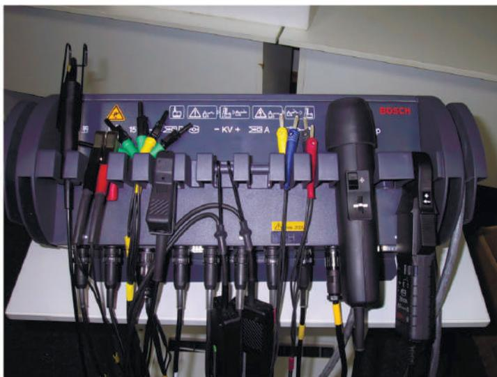
Рис. 2.128. Загальний вигляд та з'єднувальна консоль діагностичного станда FSA-74
