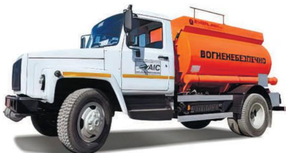
Рис. 2.28. Пересувний механізований заправний агрегат АПЗ-4,9 на базі шасі ГАЗ 3309
