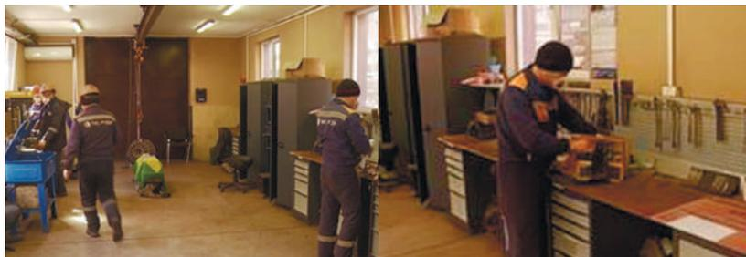
Рис. 2.46. Розміщення ремонтно-технологічного обладнання на пункті ТО (майстерні)
