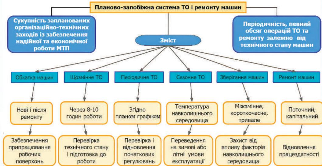
Рис. 1.28. Схема планово-запобіжної системи технічного обслуговування і ремонту сільськогосподарської техніки
