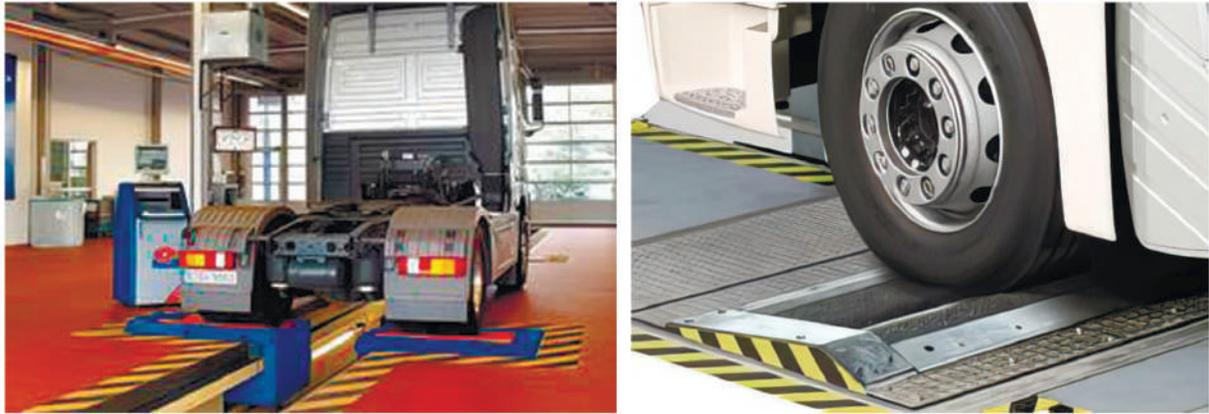
Рис. 2.130. Гальмівний стенд (IW4) MBT 4250 EUROSYSTEM
