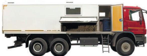
Рис. 2.26. Пересувна оливозаправна станція AVTR-АП46М6606-OS на базі шасі Mercedes-Benz Actros
