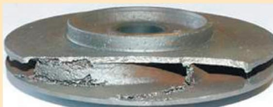
**Рис. 1.12.** Кавітаційне зношування робочого колеса відцентрового насоса
