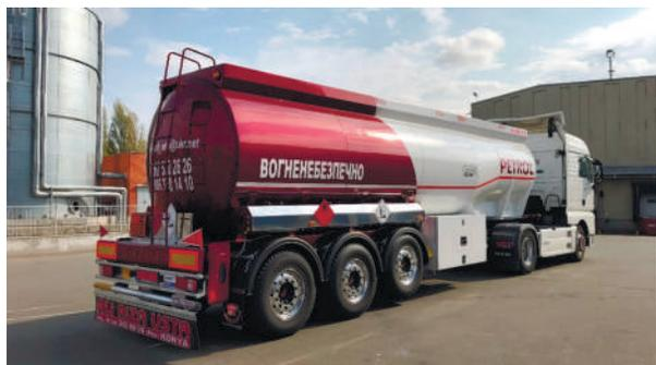
**Рис. 2.236.** Автоцистерна для транспортування і тимчасового зберігання нафтопродуктів
