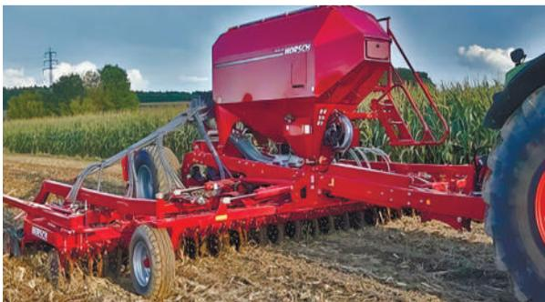
**Рис. 2.74.** Приклад простої сільськогосподарської машини, сівалка Horsch Pronto 6NT
