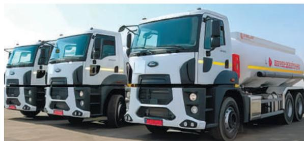
Рис. 2.29. Бензовоз на базі шасі Ford Cargo 2526
