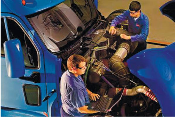
**Рис. 2.116.** Діагностування двигуна вантажного автомобіля
