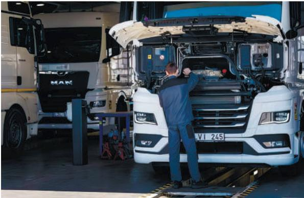
**Рис. 2.76.** Щозмінне технічне обслуговування вантажного автомобіля
