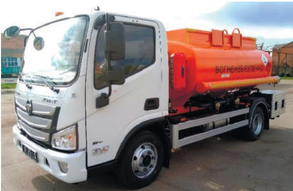
Рис. 2.237. Бензовоз на базі шасі автомобіля Foton Aumark 1088
