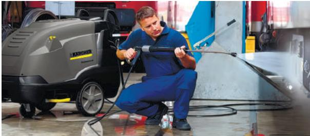
**Рис. 2.84.** Миття машини мийкою високого тиску з нагрівом HDS 8/18 4 KARCHER. Німеччина
