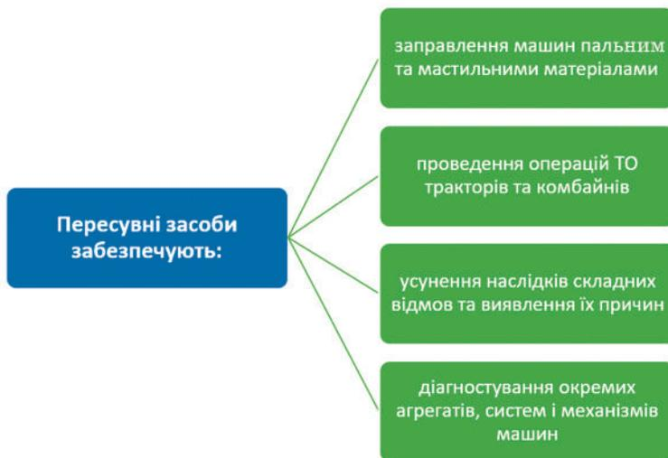
**Рис. 2.17.** Забезпечення пересувними засобами робіт з обслуговування і діагностування
