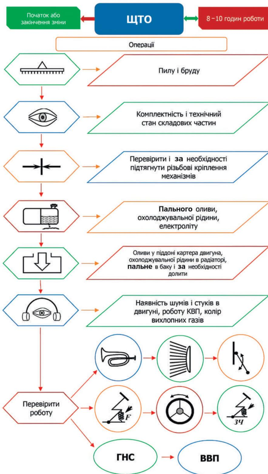
Рис. 2.72. Операції, що проводяться під час ЩТО
