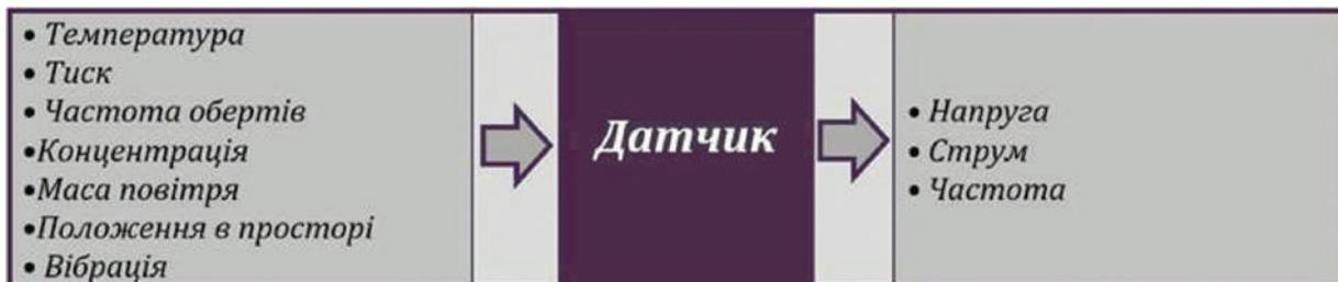
Рис. 1.22. Процес виникнення діагностичного сигналу
