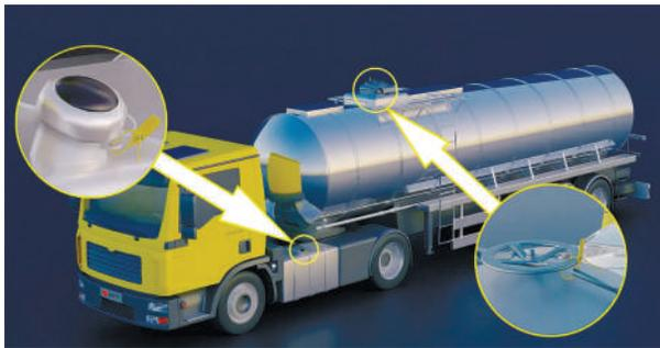
Рис. 2.213. Розташування пломб на автоцистерні
