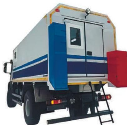
**Рис. 2.19.** Ремонтно-діагностична майстерня AVTR-AP42V4402 на шасі автомобіля-фургона Iveco з комплектом необхідного обладнання
