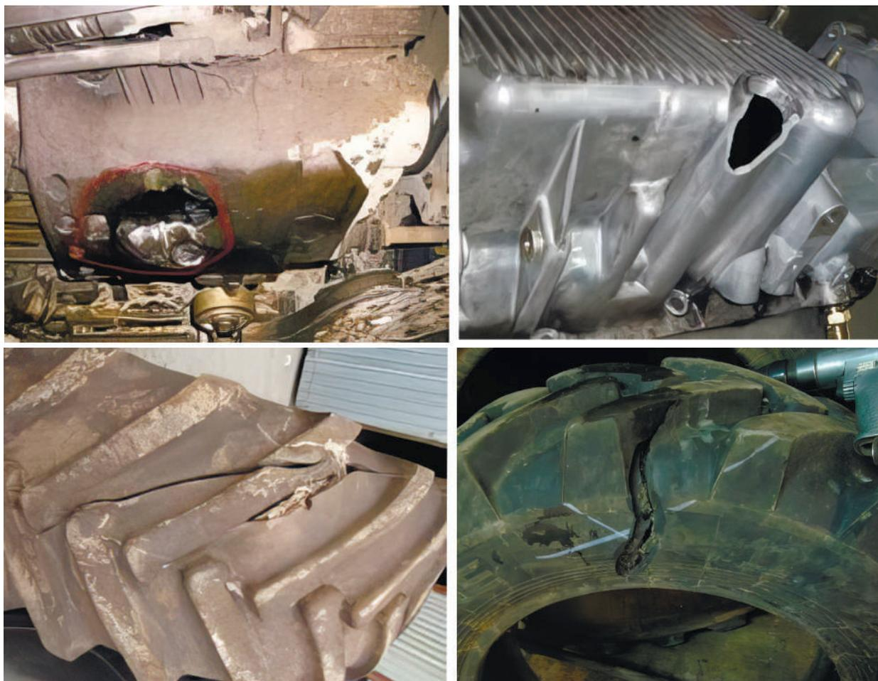
**Рис. 2.153.** Характерні несправності після роботи на кам'янистих ґрунтах
