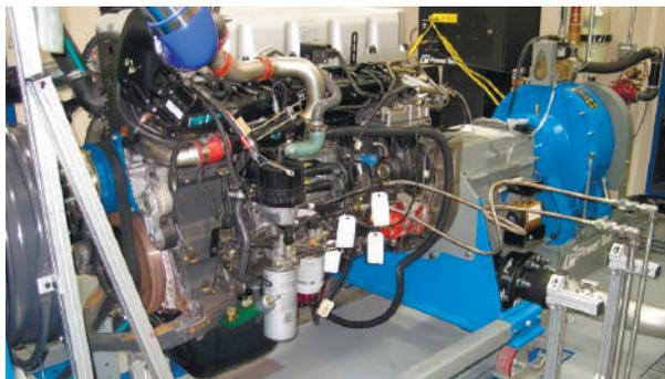
**Рис. 2.165.** Обкатування двигуна внутрішнього згорання на стенді
