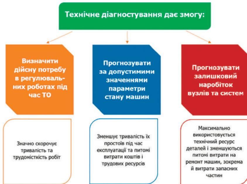
**Рис. 2.108.** Можливості технічного діагностування
