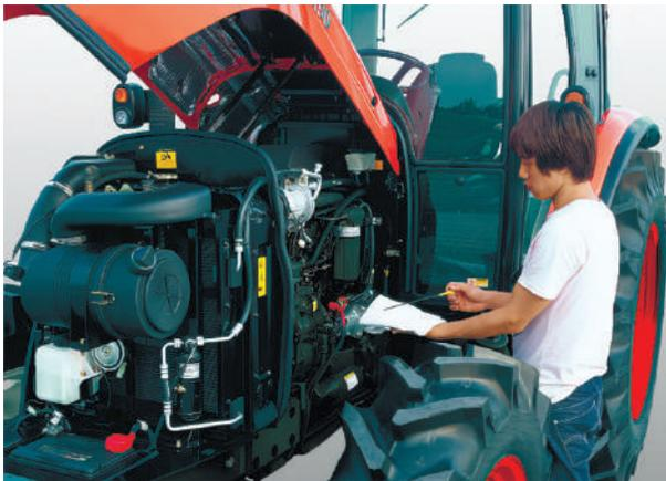
**Рис. 1.29.** Контроль параметрів технічного стану під час ТО
