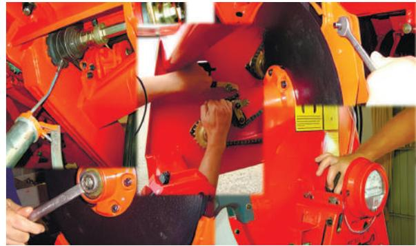
**Рис. 2.75.** Щозмінне технічне обслуговування сівалки
