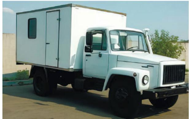
**Рис. 2.22.** Ремонтна майстерня МПР-9924 на базі автомобіля ГАЗ-3309 з необхідним обладнанням
